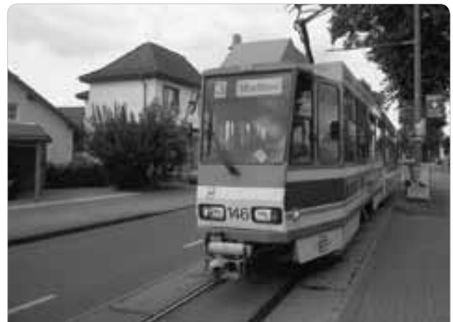
Der einzige kritische Abschnitt des fast 22 Kilometer langen Netzes liegt in der Madlower Hauptstraße: Seitenlage im Gegenverkehr.
