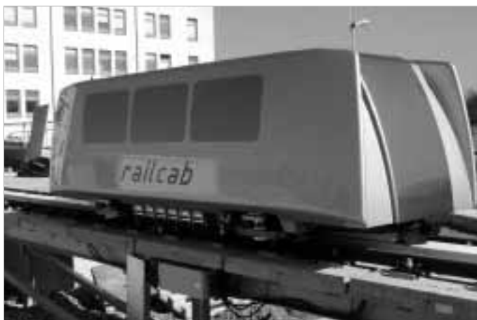
Rail-Cab: Linearmotor auf Schienen.
