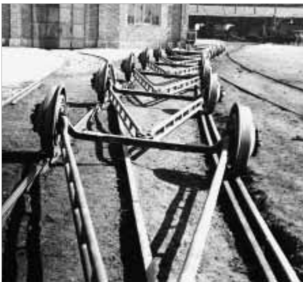
1941: Die Talgo-Idee – Schienenfahrzeuge nach Auflegerprinzip.
