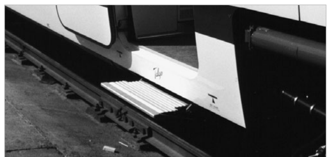
Niveaugleicher Einstieg am 760 Millimeter-Bahnsteig.
