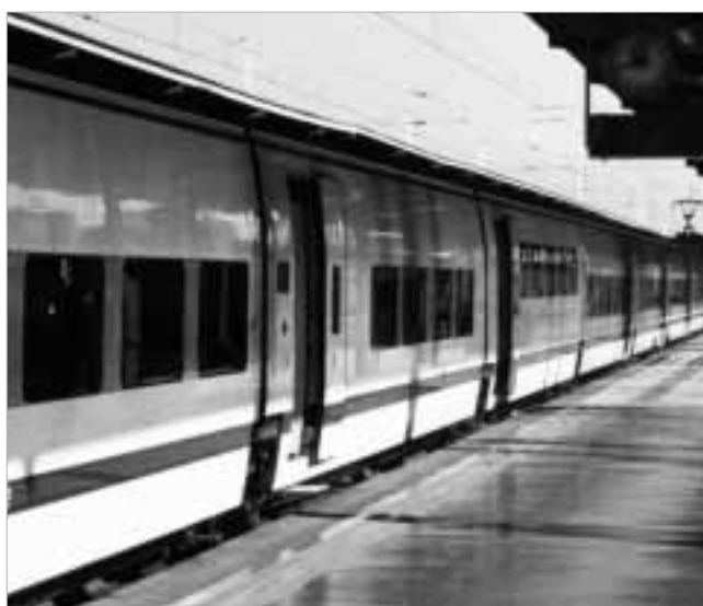
Talgo XXI am Bahnsteig – gleichmäßige Türverteilung bei durchgängiger Niederflrigkeit.
