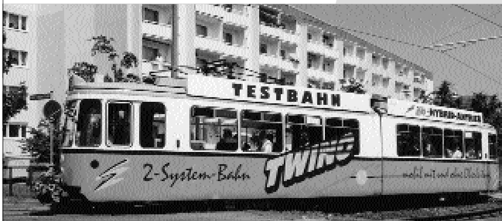
Die Hybridbahn auf dem Weg zum Krankenhaus im oberleitungsfreien Betrieb. Die dafür notwendige elektrische Energie wird mittels des Stromerzeugungsaggregats Typ UKA gewonnen.
